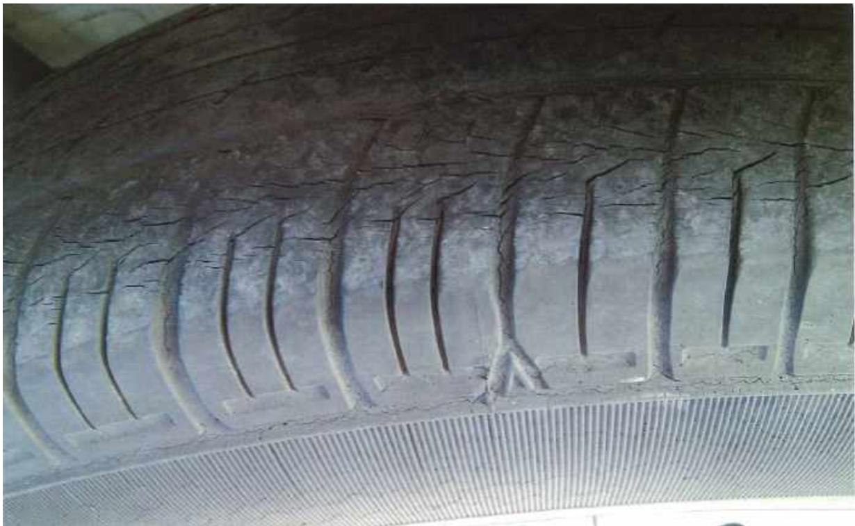
写真 12 Tire cracking タイヤの亀裂
