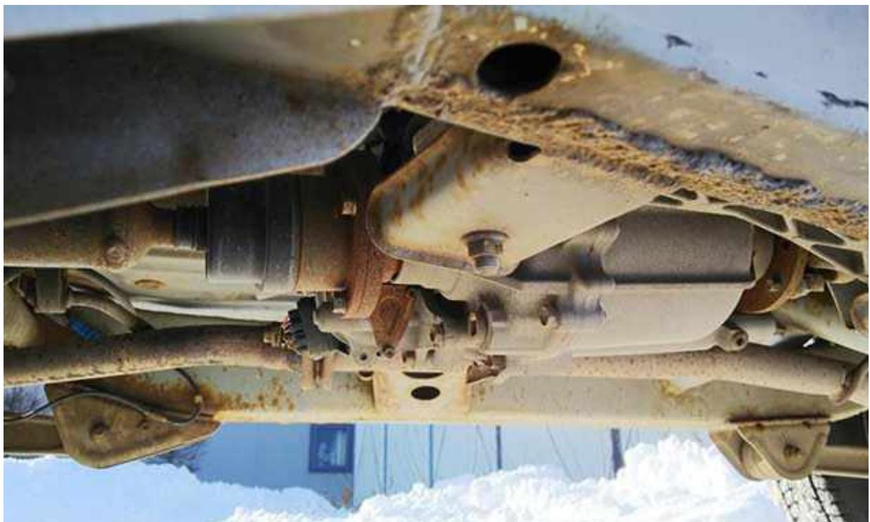
写真 7 Rust on rear differential リアデファレンシャルの錆
