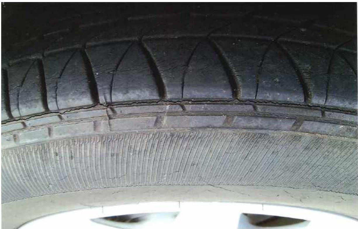
写真 10 Tire cracking タイヤの亀裂
