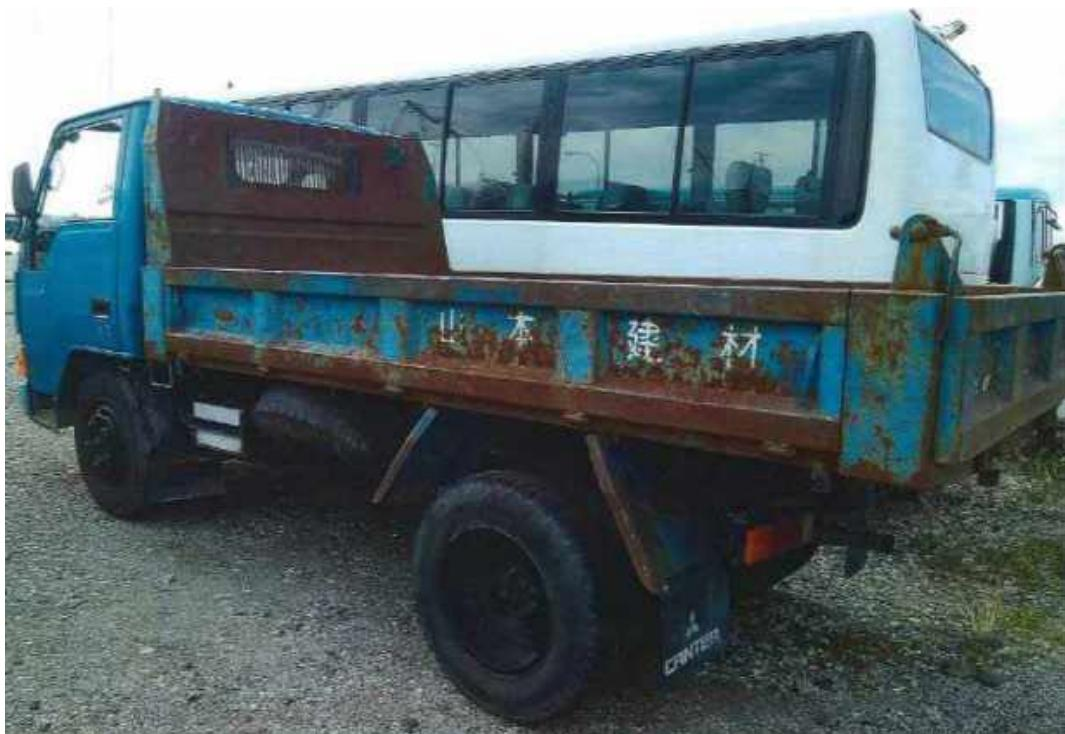
写真 22 Truck bed rusted/corroded トラック荷台の錆・腐食
