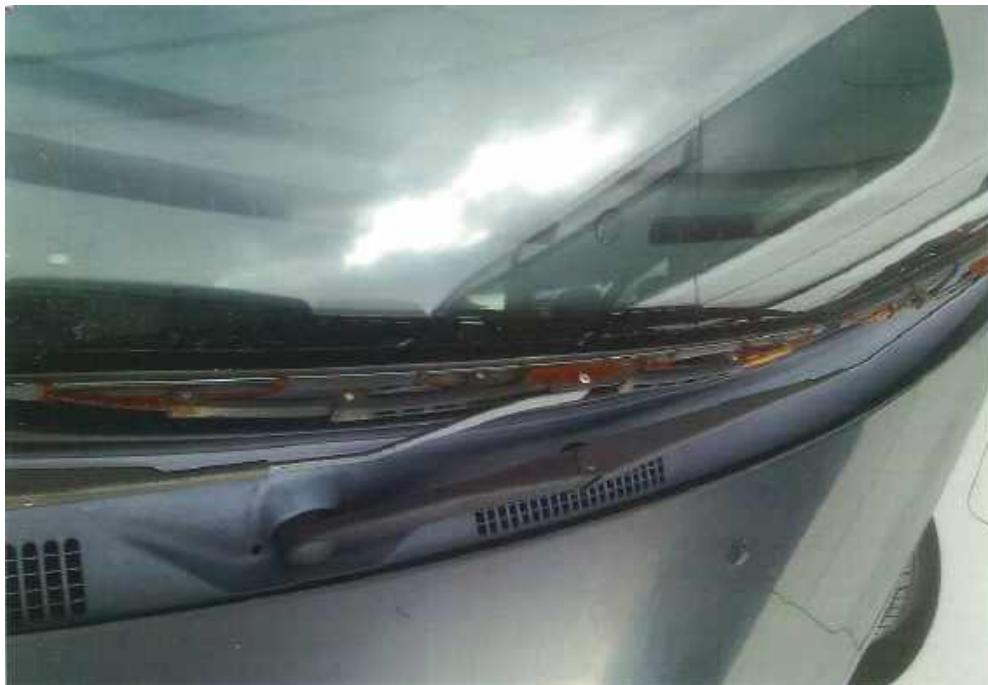
写真 20 Wiper rubber broken ワイパーゴム切れ
