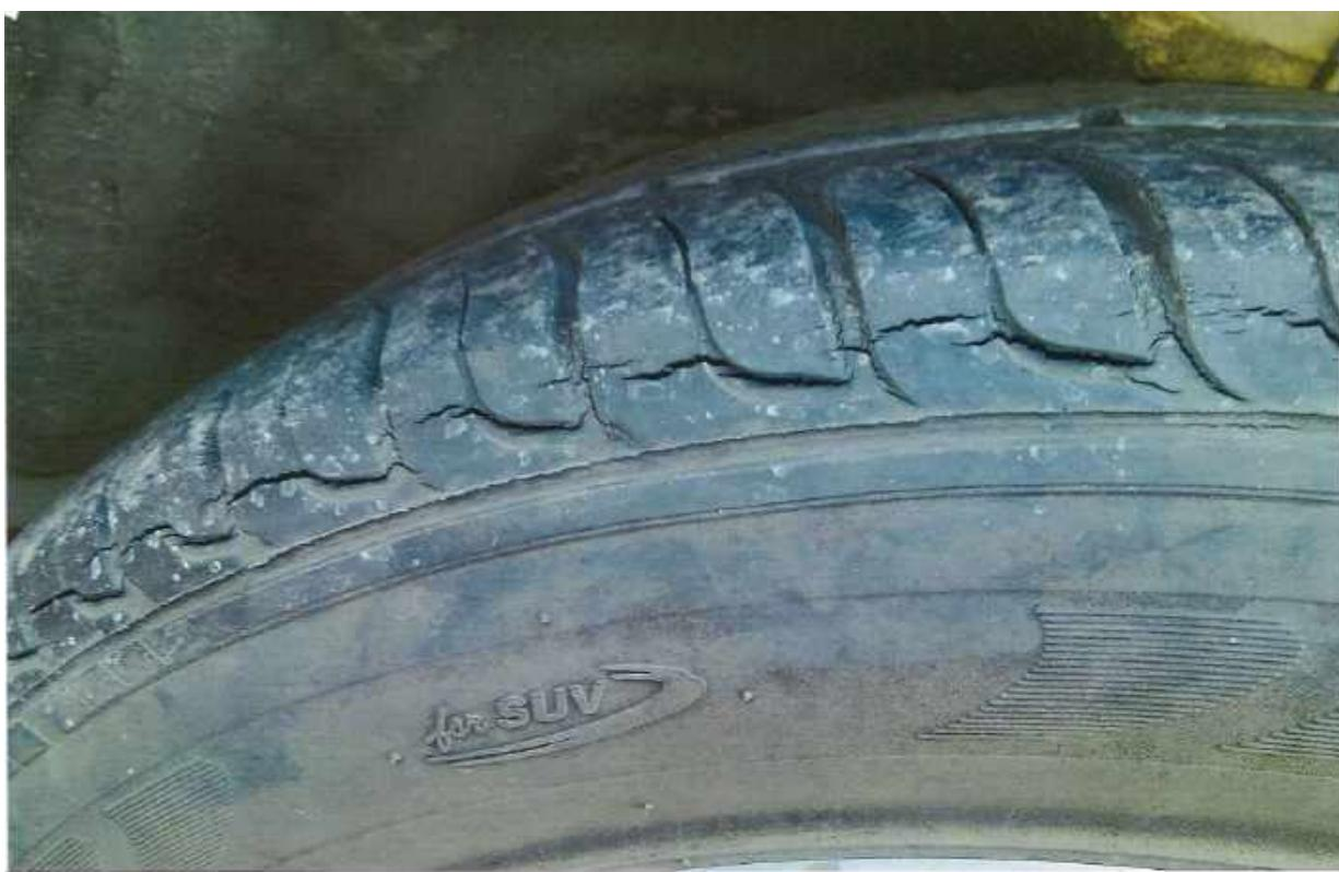
写真 11 Tire cracking タイヤの亀裂
