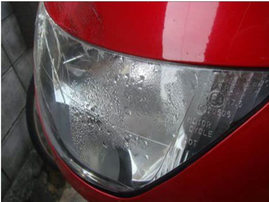
写真 18 Lens covered or not clear レンズに塗料付着
