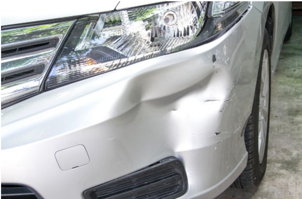
写真 3 Bumper damage バンパーの凹み
