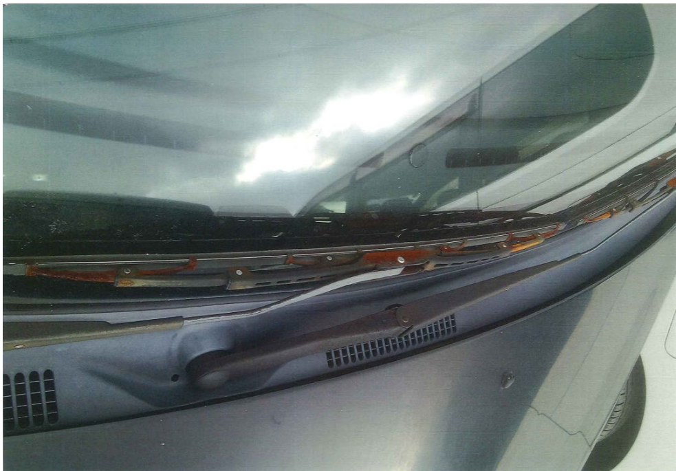
写真 19 Wiper arm rust ワイパーアームの錆
