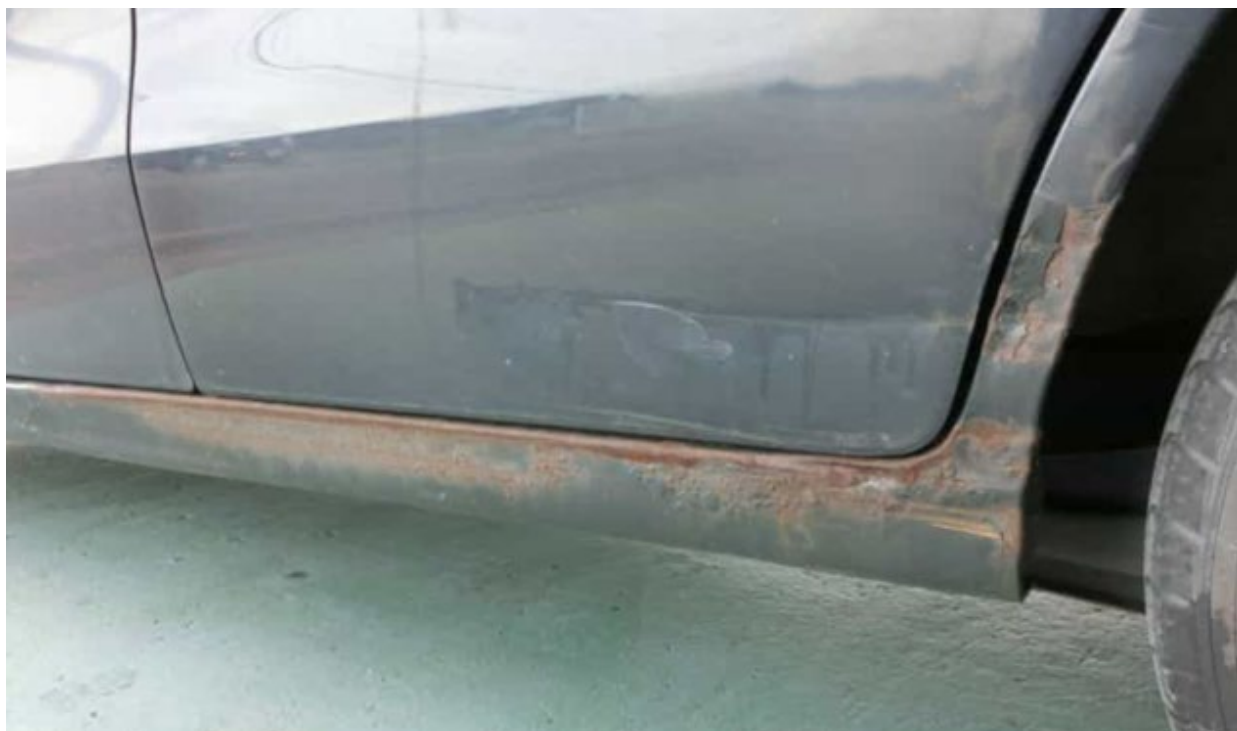
写真 2 Quarter panel hole/rust クォーターパネルの穴・錆
