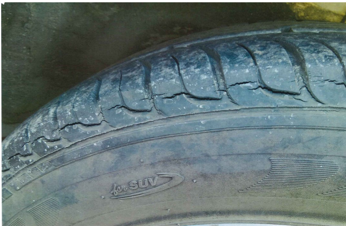
写真 10 Tire cracking タイヤの亀裂
