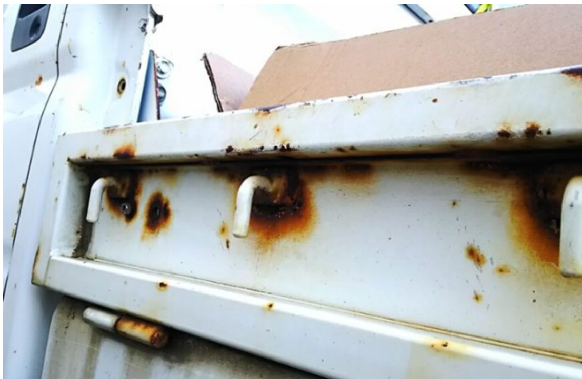
写真 22 Truck bed rusted/corroded トラック荷台の錆・腐食
