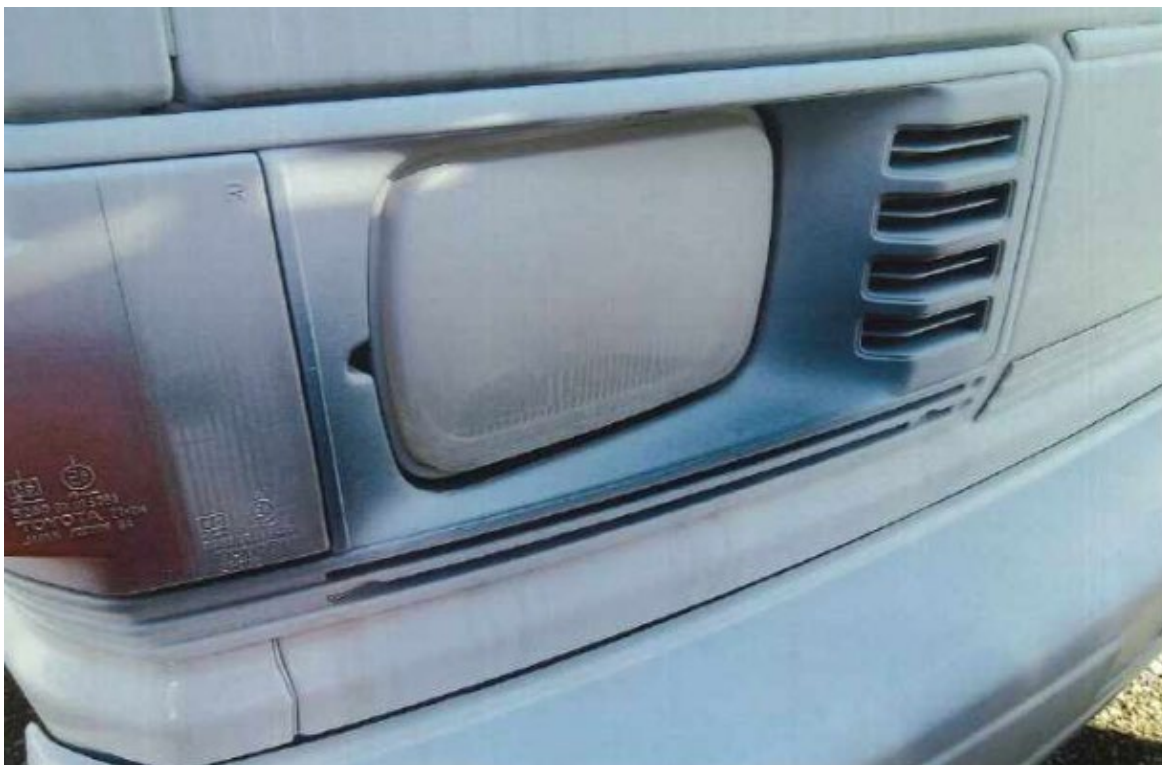
写真 18 Lens covered or not clear レンズに塗料付着
