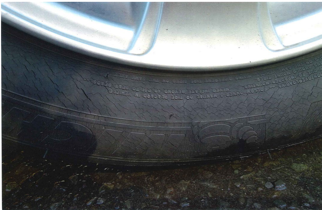
写真 12 Tire cracking タイヤの亀裂
