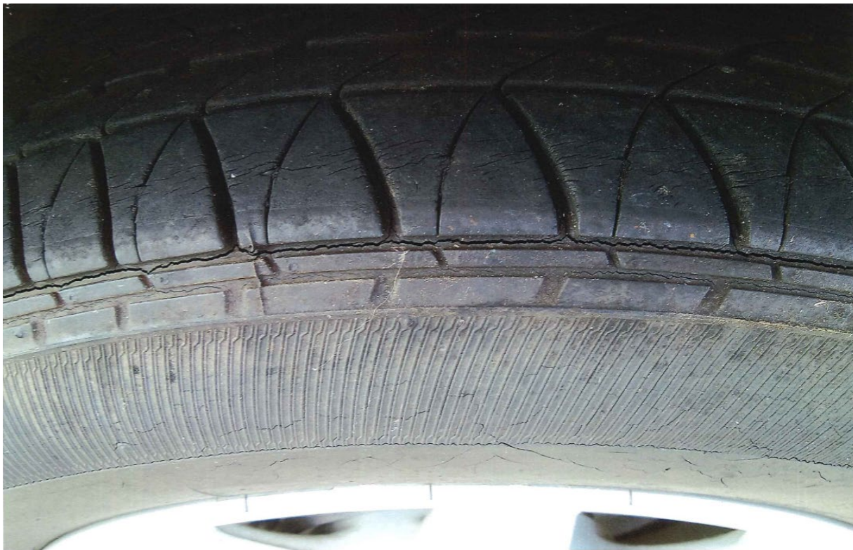
写真 10 Tire cracking タイヤの亀裂
