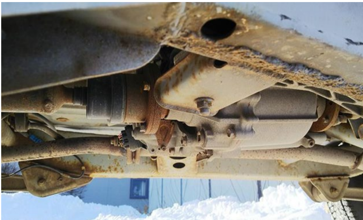
写真6 Chassis rust/corrosion シャシーの錆
