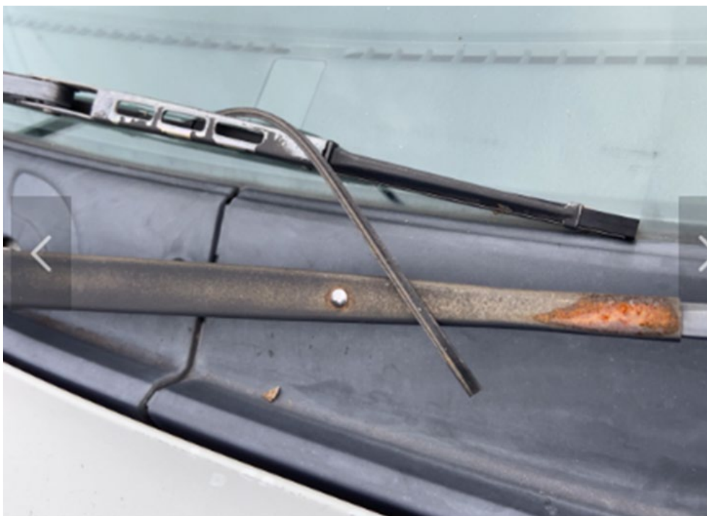
写真 20 Wiper rubber broken ワイパーゴム切れ
