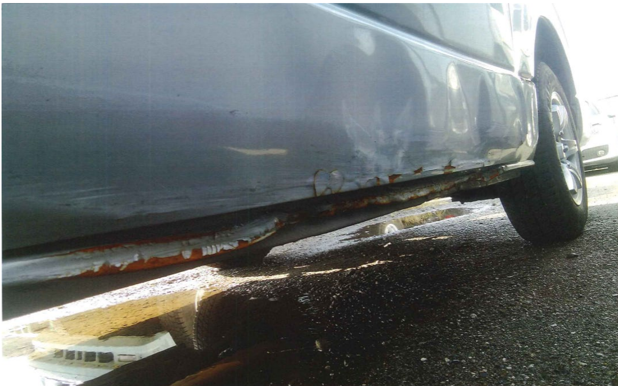
写真8 Rust/corrosion at the bottom of the side sill サイドシル下部の錆・腐食
