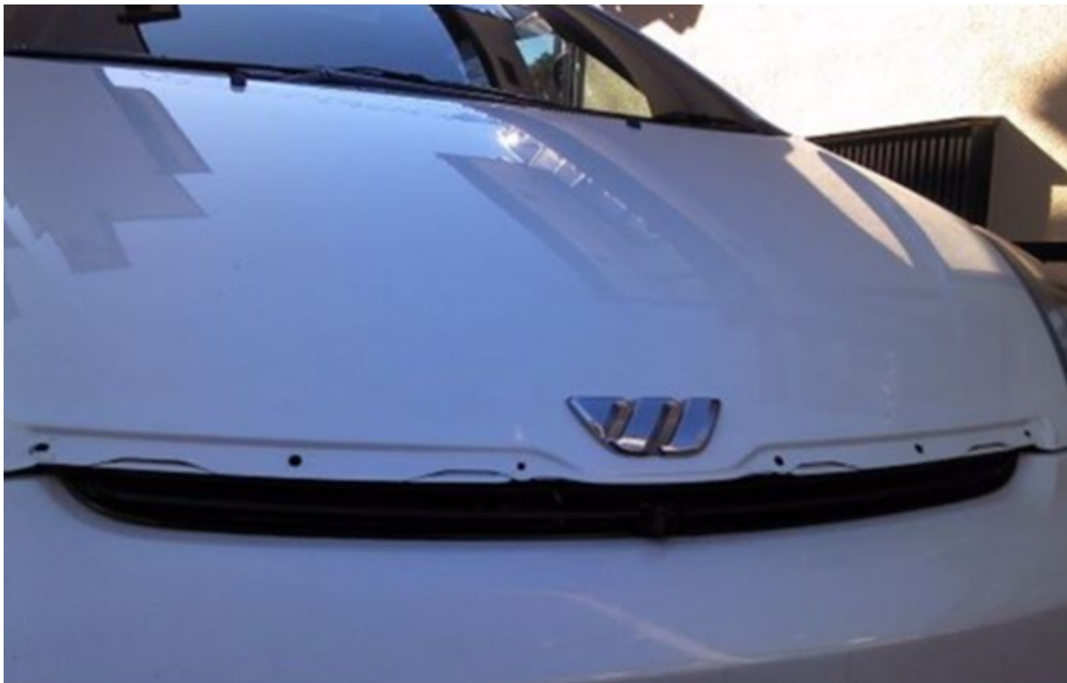
写真 4 Missing bonnet parts ボンネットエンド部品の欠損
