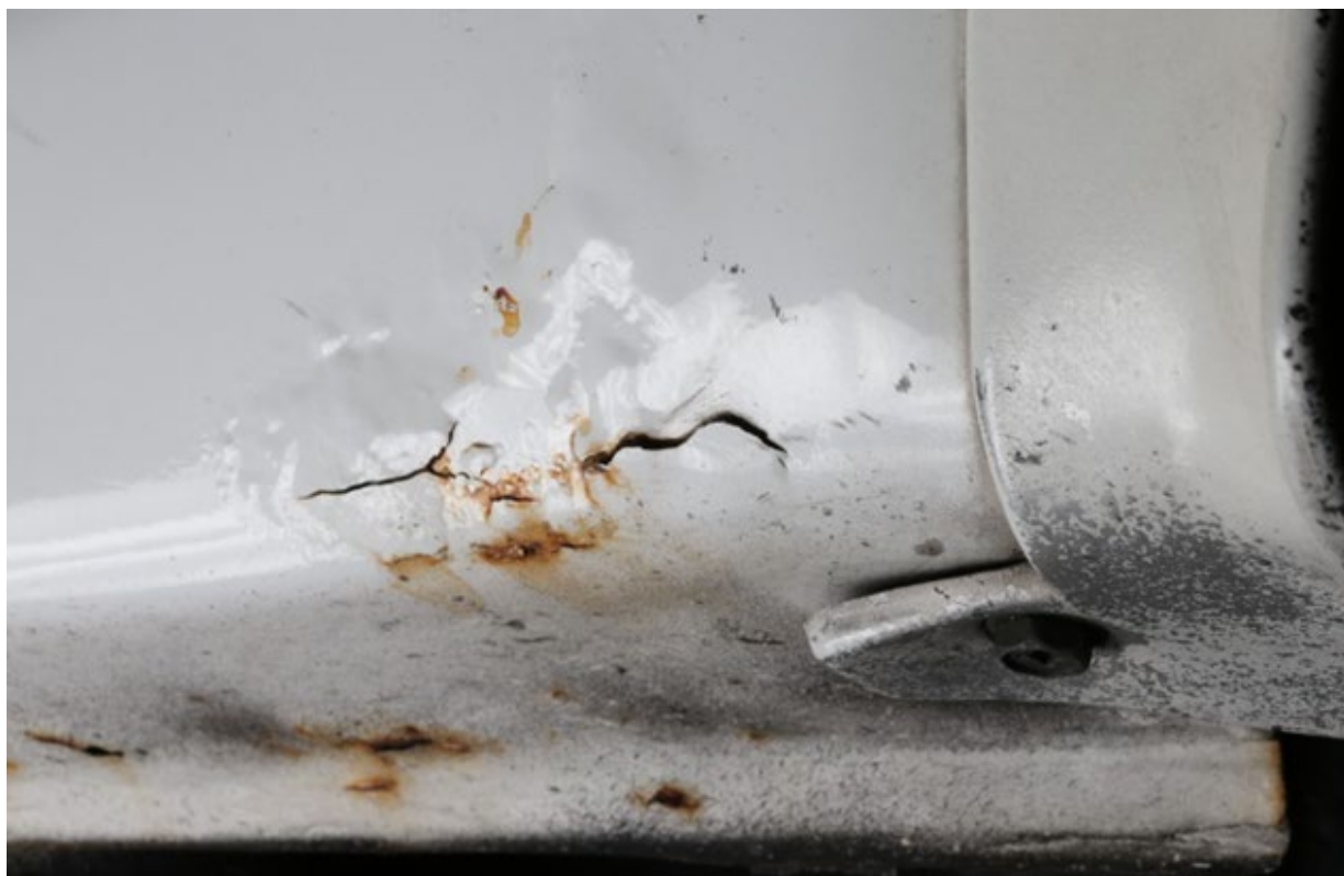
写真 2 Quarter panel hole/rust クォーターパネルの穴・錆
