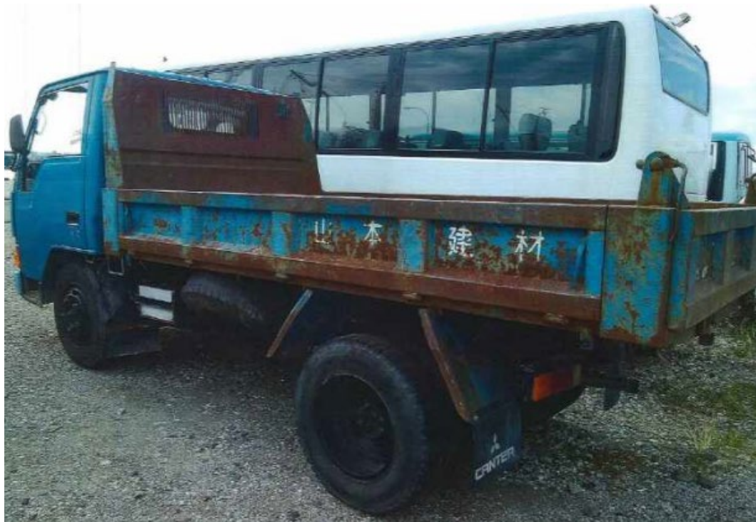
写真 21 Truck bed rusted/corroded トラック荷台の錆・腐食
