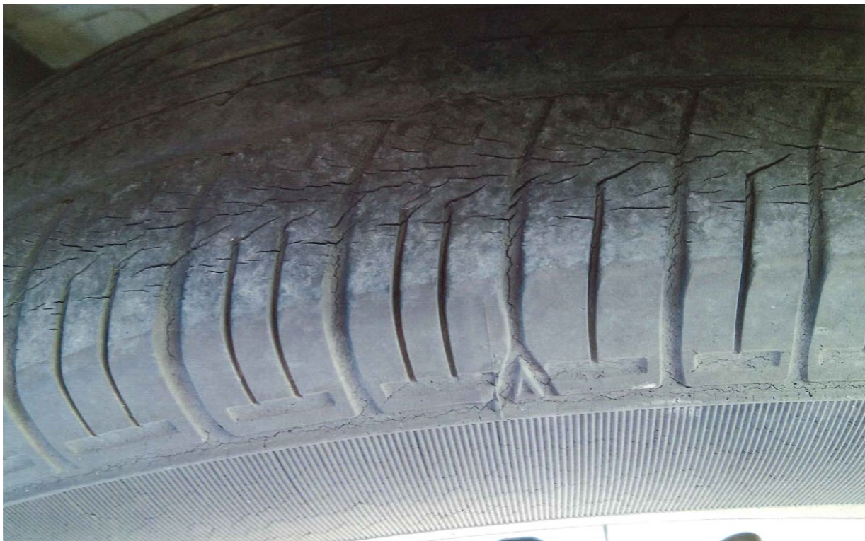
写真 12 Tire cracking タイヤの亀裂
